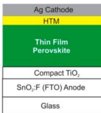
5-сурет. Планарлы құрылымды перовскит негізіндегі күн элементі [4]
